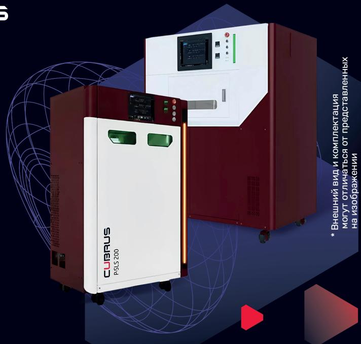
Технология селективного лазерного спекания (SLS) – это аддитивное производство путем послойного спекания порошковых полимеров и других материалов. Она позволяет создавать функциональные детали сложной геометрии без поддерживающих структур, сокращая время и затраты на постобработку.
